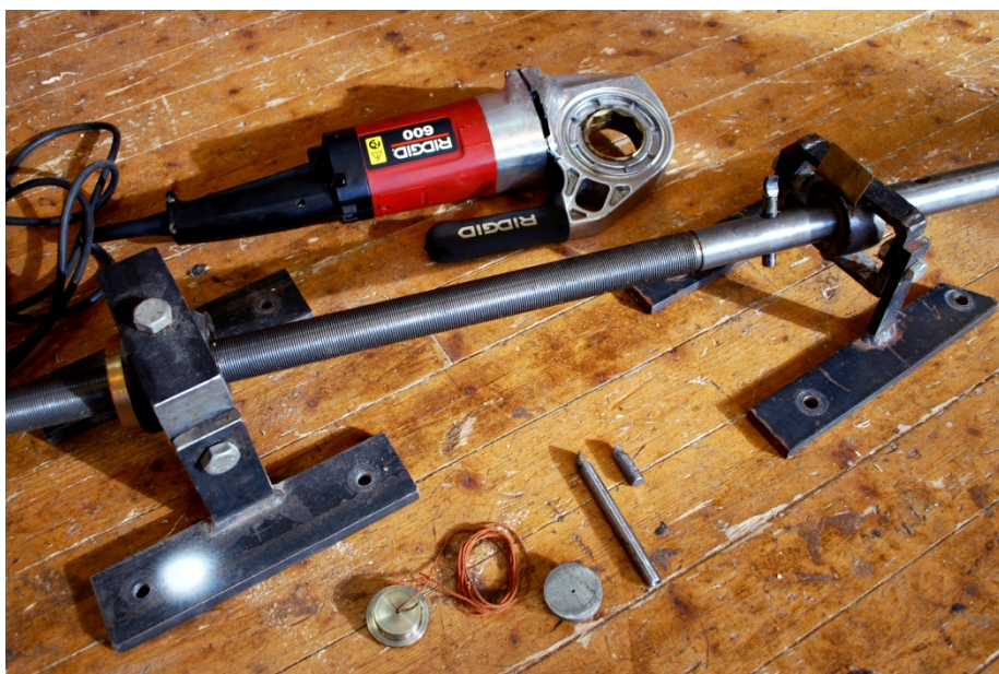
På større trefartøy kan det bli snakk om ganske store hull i forbindelse med hylse. Da nytter det ikke med vanlig bor, tappjern eller hullsag – da må man ty til utstyr ala dette.
