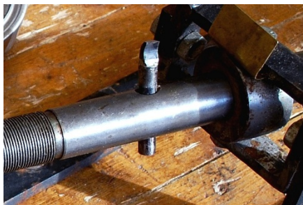
Skjærene settes i hull på tvers av gjengestanga, og festes med settskruer.
