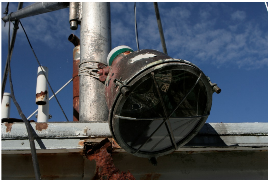
Denne arbeidslampa er kanskje i dårlig forfatning, men den har fortsatt sine skjøreste deler intakt. Den kan dermed bli «donor» for å istandsette ei tilsvarende lampe.
