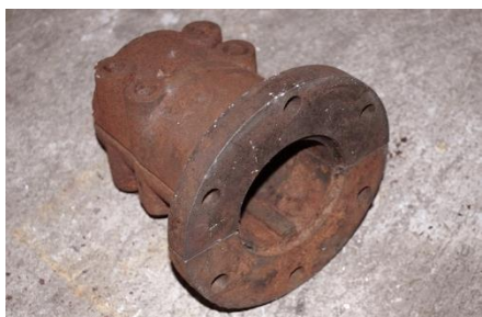
Koblingsflens. Slike monteres på akslingene på utgående aksling fra motor, og på propellaksling, for så å skrues sammen mot hverandre.
