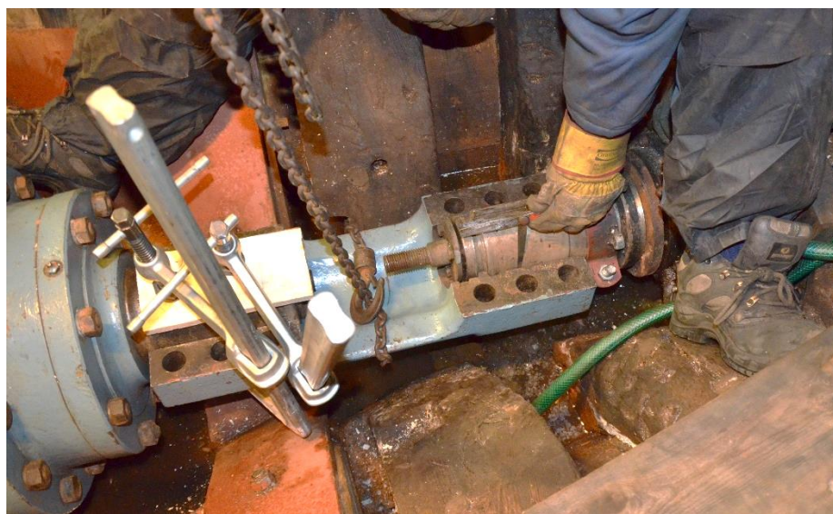
Litt improvisasjon. Her er halve klemflensen montert fast på motorens utgående aksling, og brukt som "rettholdt". Bladsøker brukes til å kartlegge hvor avviket er størst. Utifra målingene danner man seg et bilde av hvordan motoren må flyttes for at akslingene skal bli på linje.
