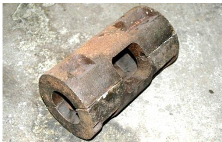
Klemflens. Denne klemmes om utgående aksling fra motor og propellaksling.
