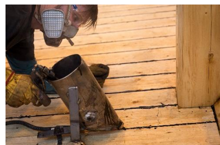
Nordnorsk Fartøyvernssenter har laget seg ei elektrisk bekhøne. Fyllinga styres via et pistolgrep.
