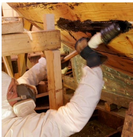
Et skaft surret med ei bomullsfille fungerer fint som bekkost. Kosten må gjerne roteres gnikkes med for å få beket skikkelig inn i natene.
