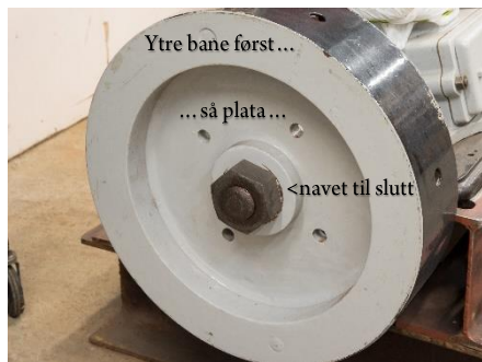
For å unngå at svinghjulet sprekker ved bruk av varme, er det viktig at man starter ytterst!
