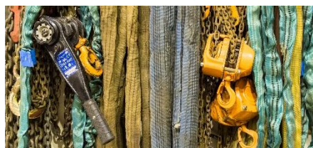
Gode og riktig dimensjonerte løfteredskaper er viktig. Kjettingtaljer er fine ettersom de gjerne gir god kontroll over løftet. Løfteoperasjoner må planlegges godt slik at man får man objektet trygt dit man har tenkt. Bruk relevant verneutstyr. Vurder hvilken risiko løftet innebærer, og hvor det er trygt å bevege seg
