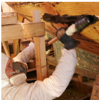
Beking av skrog ved hjelp av pinne surret med filler. Legg merke til bruk av verneutstyr. Under arbeid med oppvarmet bek, skal alltid maske med filter minimum A2P2 benyttes, eller friskluftsmaske. Vernebriller og tiltak som beskytter huden er også anbefalt.
