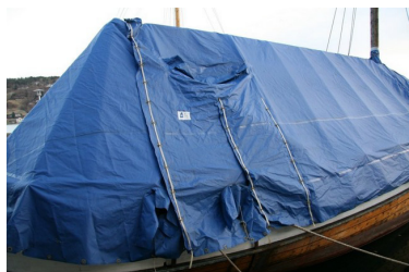
Overdekningen på M/K Vikingen. Mønekammen er lagt over styrhuset. Legg merke til reiminga ved åpningene. Lastebilstrikk eller andre fleksible løsninger er å anbefale.
