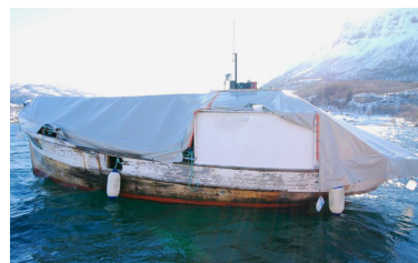
Overdekningen på M/K Brottsjø er av relativt tung duk med sveisede maljer, formsydd og tilpasset rundt styrhuset.
