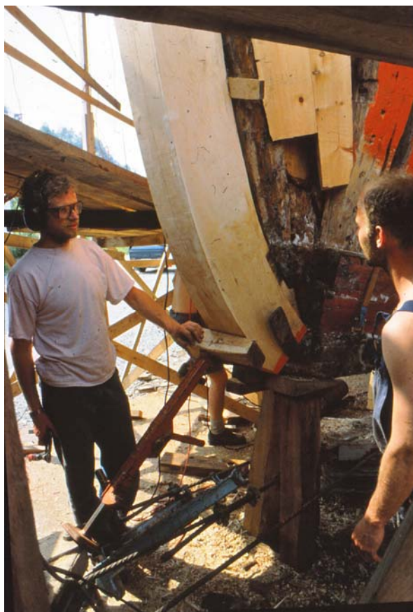
Ytterstevnen er på plass. Foto:HFS
