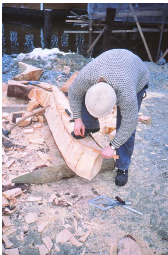
Åsmund Kristiansen i gang med å smi til et spant i akterskipet. Foto:HFS
