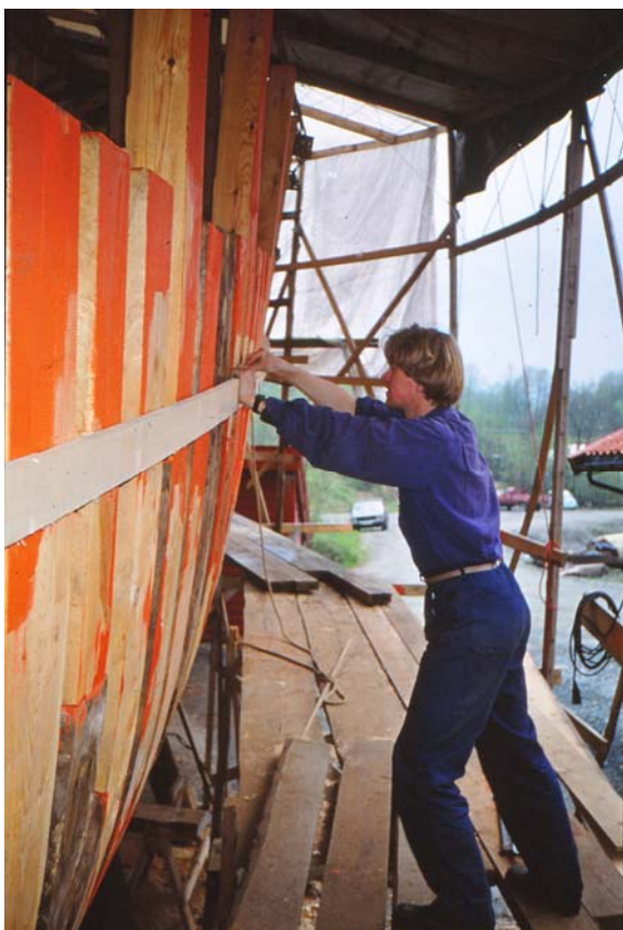
Spantene slettes av før huden kommer på. Foto: HFS
