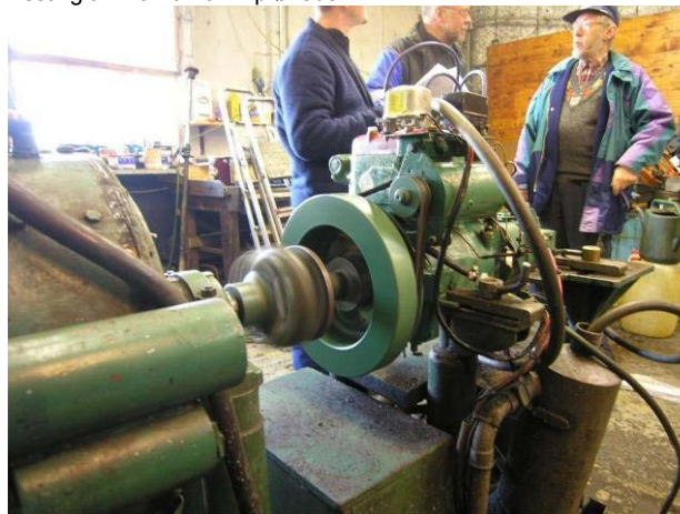
Testing av Marna 10 A i prøvebenk:
