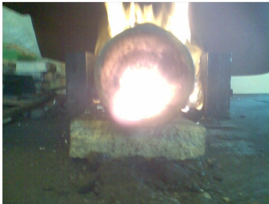
Prøvestykkene oppvarming til >900 grader C
