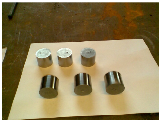
Prøvestykket ble delt opp i seks stykker á 40 mm
