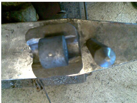
Knapt synlig spor etter kjørneren i overflaten.
