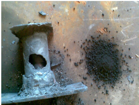
Da kassen ble tatt ut av slagghaugen viste det seg at det var brent hull i den.
