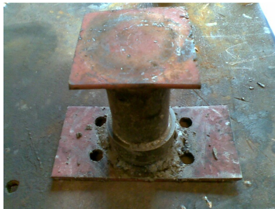
Kasser (rørform) med lokk laget av svartjern rør i 50 mm
