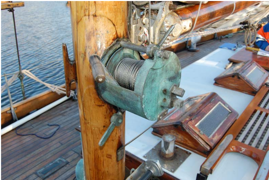
Solide detaljer i riggen. Her fallvinsj, muligvis fra tiden i England. Mast i spruce.
