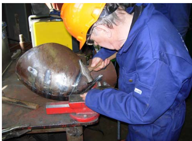
Leif Gulliksen banker lufthettas strupeestykke til rett form. Bredalsholmen 4. mai 2007. (Foto: Endre Wrånes).
