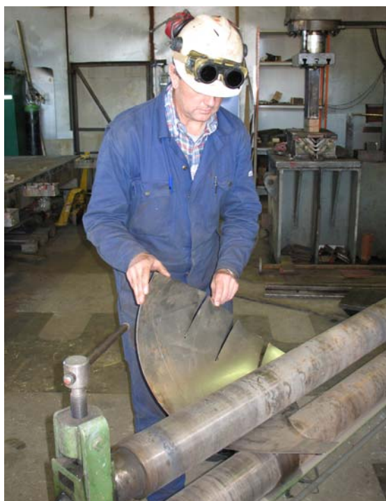
Platedelene valeses i konvensjonell vals. Dette er en av de øverste delene. Legg merke til utkappene langs rygg-siden, som skal gjøre dobbelkrummingen lettere. Foto: (Endre Wrånes).
