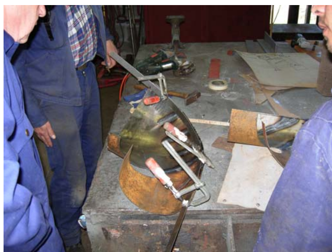
Beregning av overmål som skal kappes bort langs ryggpartiet på en av lufthettas halvdel, før den settes sammen med den andre halvdel. (Foto: Endre Wrånes).
