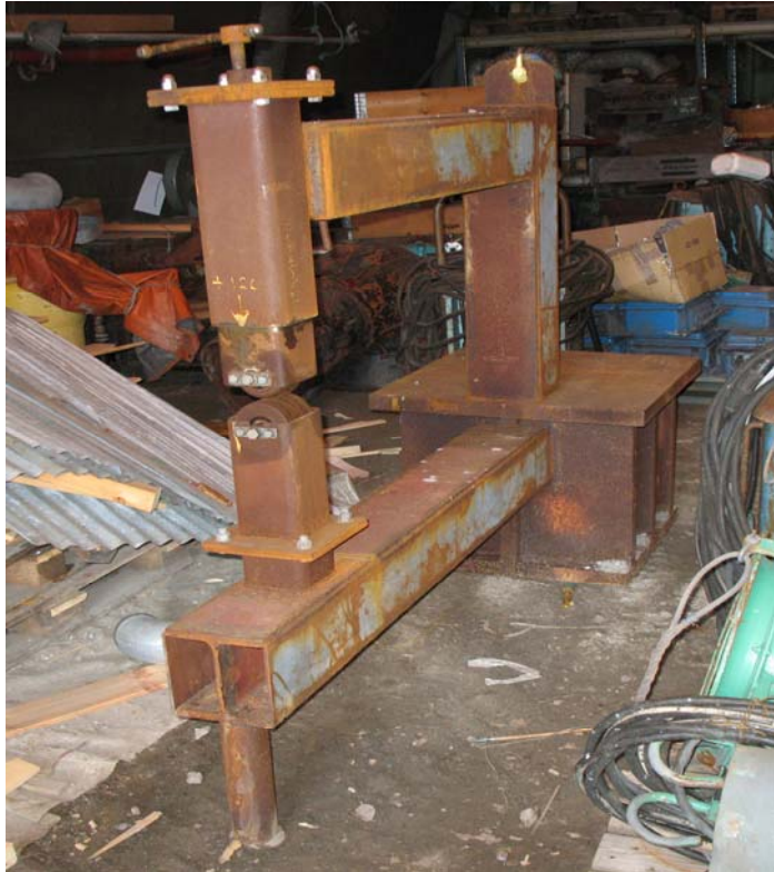
"Det engelske hjul," bygget av Trygve Larsen ved BDF, her lagret i et skjul på Bredalsholmen. Denne maskinen måtte fungere som substitutt for Øya Verksteds spesiallagede vals under byggingen av lufthetter ved Bredalsholmen sommeren 2007. (Foto: Endre
