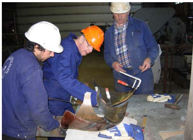
Leif Gulliksen instruerer håndverkere fra Bredalsholmen i hvordan en beregner overmål. Dette kappes bort før delene settes sammen. (Foto: Endre Wrånes).
