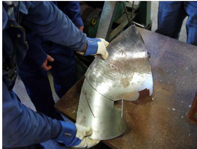
En valset underdel og overdel holdes mot hverandre, slik de skal sveises sammen. Til sammen utgjør de en halvdel av lufthetta. (Foto: Endre Wrånes).
