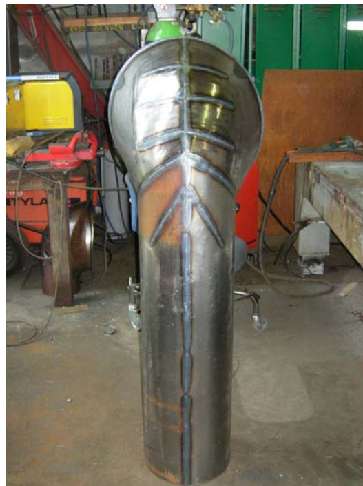
Ryggdelen av ei ferdig sammensatt lufthette. Her er sveisesømmene mellom hettas ulike deler, samt utkappene på de øvre platene, godt synlige. (Foto: Endre Wrånes).
