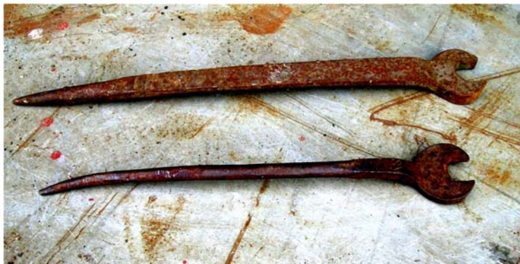
Platenøkler med spiss ende til å rette inn plater fra naglehullene
