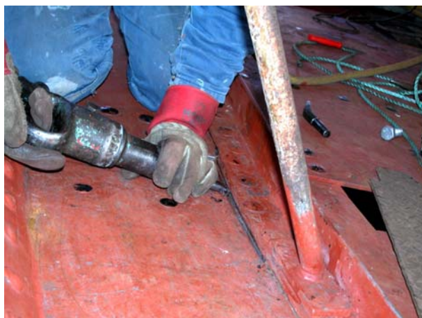
Rennesteinsvinkel dikkes mot rennesteinsplate
