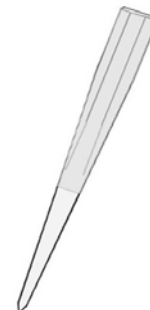
En egnet malkjørner for malbord er slank, for å unngå sprekke-dannelser i malbordet
