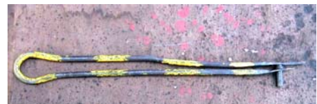
To typer nagletenger, den nederste med nagle i grepet
