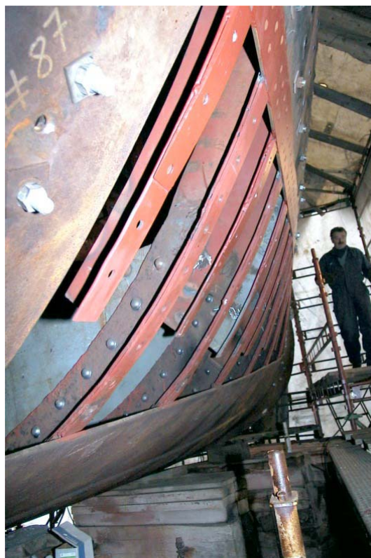
Kiler er montert for platemontering. Den nye platen vil overlape innenfor nedre plategang og utenfor øvre plategang. Kilene er imidlertid montert med sveis, et metodevalg vi skal unngå.
