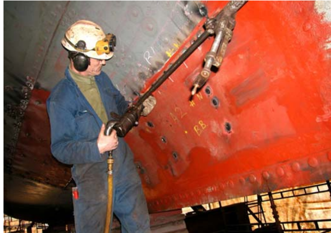
Bruk av klinkeroppheng, letter arbeidet
