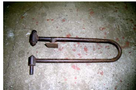
Overmerker, for overføring av merker ved kjøring, fra den ene platesiden til den andre
