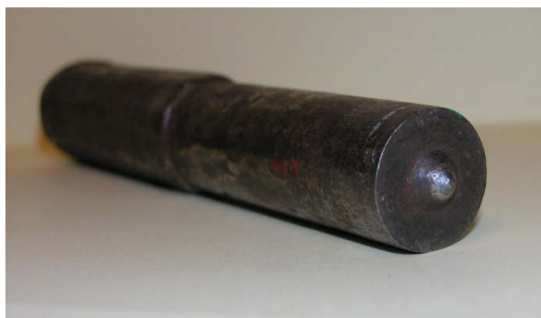
Senterkjørner for merking direkte fra original-til ny plate
